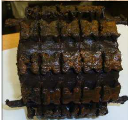
Filtr po 44 dniach procesu filtracyjnego
