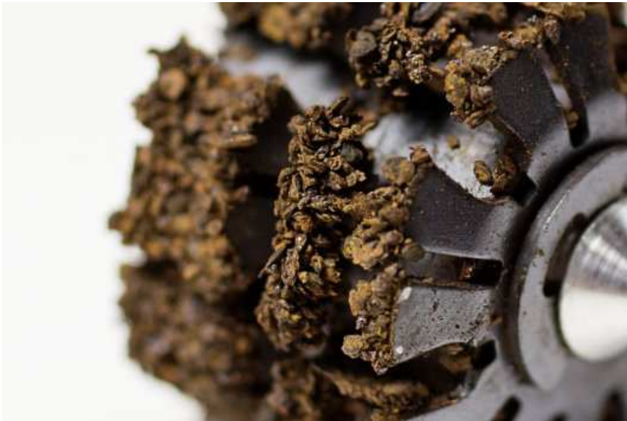
Rys.4. Zanieczyszczony segment filtra
